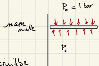
② On applique le P.F.S (Principe Fondamental de la Statique) au piston
